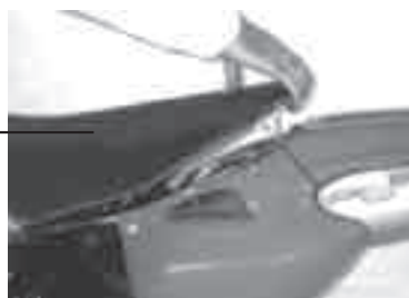
1. Retirer la vis (A) et retirer le siège (B).
