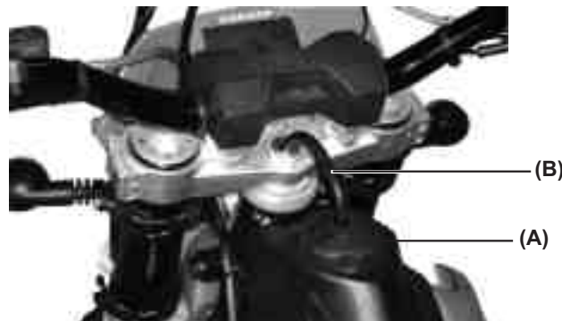
(A). Bouchon du réservoir. (B). Tuyau de ventilation des vapeurs.
